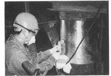
経年火力設備診断技術における レプリカ採取
