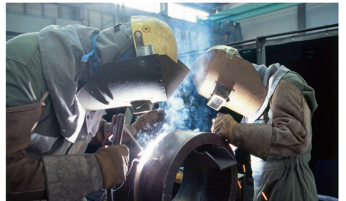
厚肉管溶接模擬(溶接工場)
