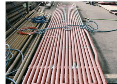
ボイラーチューブ加工
