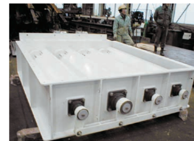
換気設備風量調整ダンパー製作
